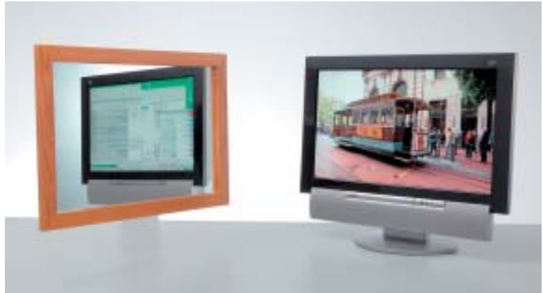
デュアルビュー液晶の試作機。 右方向にはテレビ動画を、左方向にはインターネット画像を同時に表示。 インターネット画像は鏡のなかに見える。
